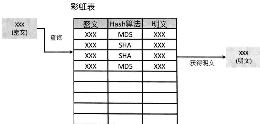
图 3-17 彩虹表法破解 Hash 算法原理
